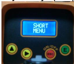
jedinice će treperiti. Dok taj pokazivač treperi pritiskom na dugme "**GORE**" možete da menjate mernu jedinicu u kojoj podešavamo vrednost (udarac u minuti "SPM", udarac na sat "SPH", litara na sat "LPH").
